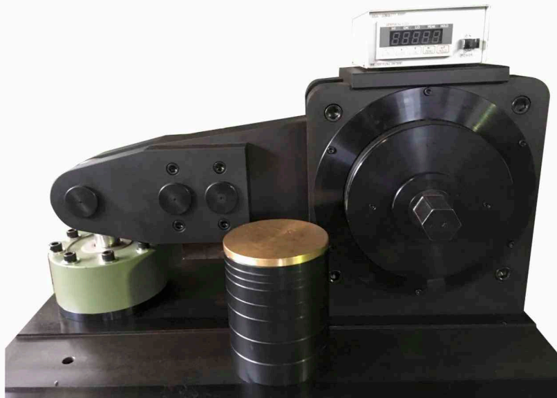
トルク試験機：TT-6000 最大計測トルク：58,840 Nm
