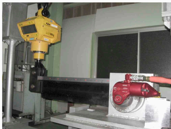
トルク試験機：BT-TS-01 最大計測トルク：49,000 Nm
